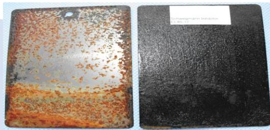
Abb.1 Stahlblech, unbehandelt / Stahlblech mit SCHWEGO® inhibitor 6817 nach der Reaktionszeit
